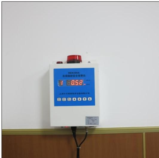
图 15 固定式剂量率仪
